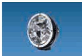
**HELLA Luminator LED Fernscheinwerfer** mit LED-Positionslicht, Mit Klarglasoptik, inkl. LEDs, Gehäuse und Befestigungsbügel aus Alu-Druckguss mattschwarz beschichtet, Glashalterahmen verchromt. Kennzahl 40, ohne Leuchtmittel, Artikel-Nr. 3674 3992
