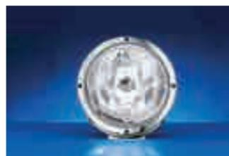
**HELLA Luminator Chromium Fernscheinwerfer** mit LED-Positionslicht, robustes Metallgehäuse aus verchromtem Zinkdruckguss, Klarglas ø224 mm, mit LED-Positionslicht, Glasstreu-scheibe in Klarglasoptik, verchromter Glashalterahmen, High-Boost-Reflektor, ohne Leuchtmittel, Art.-Nr. 3674 0451
