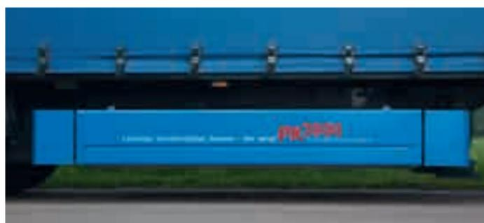
**MEGA-Trailer Kasten**, Korpus verzinkt oder KTL-beschichtet, Deckel KTL-beschichtet optional Pulverbeschichtet, **350 mm Innenhöhe**
