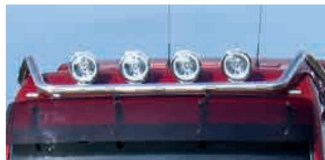
**Typ Hydra\*** mit seitlicher Reling, vorverkabelt, mit Schellen zum Anschließen von 4 Scheinwerfern\*, inkl. 12 orange + 5 weiße LED-Leuchten
