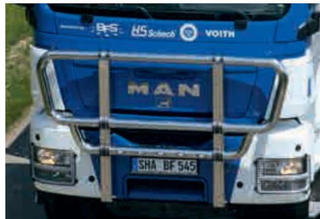
**Typ Standard\*** für TGS, Stahlstoßstange, Artikel-Nr. 50021403
